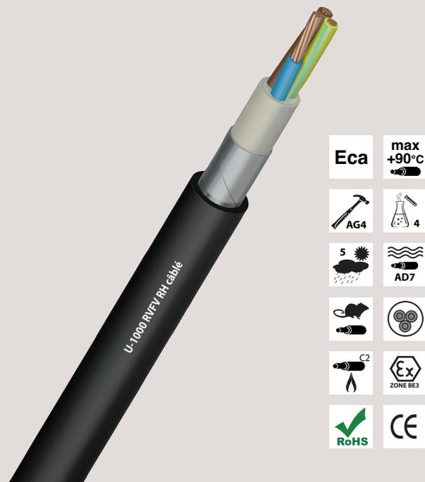
**NF C 32-322 ou XP C 32-322<sup>(\*\*)</sup>** : câbles rigides isolés au polyéthylène réticulé sous gaine de protection en PVC, armé - série U-1000 RVFV.
