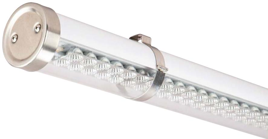
Luminaire formé d'un fourreau en polycarbonate de diamètre 75mm bimatière opale / transparent. Optique à facettes en polycarbonate aluminisé.
