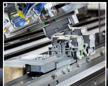
Équipement automatique des borniers et repérage via système de marquage laser
