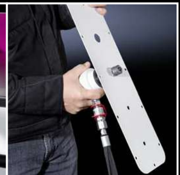
Réalisation de découpes dans l'acier et l'acier inoxydable (accessoires tuyau et vérin hydrauliques, voir page 645)
