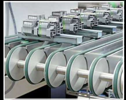
Unité de tri et stock tampon pour borniers conditionnés
