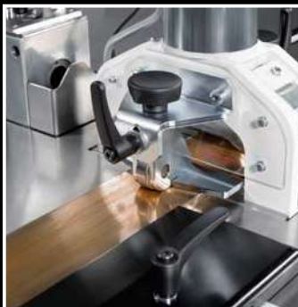
Coupe des barres de courant à l'aide d'un laser de précision intégré
