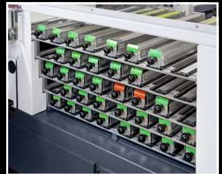
Approvisionnement de jusqu'à 80 magasins pour borniers, coupe-circuits à fusible, etc.
