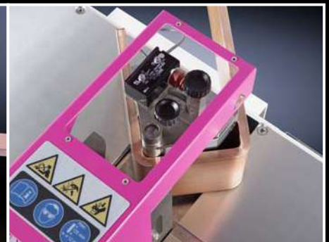
Cintrage d'une barre de courant
