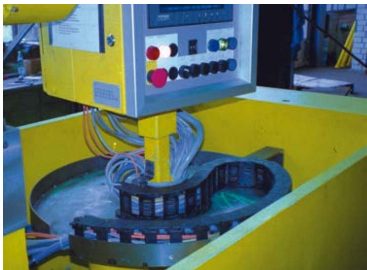
CHAÎNE COLIBRI POLYAMIDE Pupitre de commande - Industrie
