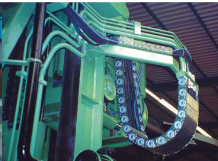
CHAÎNE ACIER SLP 325 Gerbeur - Logistique
