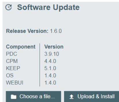
Fig. 6-9: Mise à jour du logiciel par interface Web
