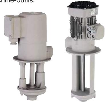
Les pompes de refroidissement sont des pompes centrifuges avec corps d'aspiration immergé, entraînées par un moteur asynchrone à cage, formant corps avec la pompe. De conception moderne, les pompes 4 COA permettent une adaptation facile sur toutes les machines- outils.
