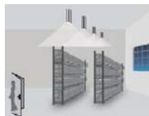
Si aucun mouvement n'est détecté, le luminaire éclaire à un seuil en % défini, selon réglages.
