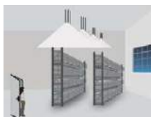
Si une personne est détectée, le luminaire s'allume à 100%, selon réglages.
