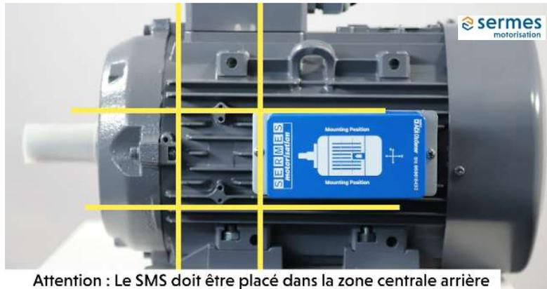
Attention : Le SMS doit être placé dans la zone centrale arrière
