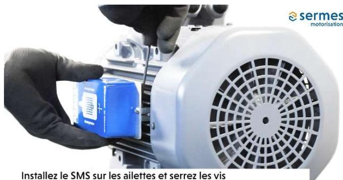
Installez le SMS sur les ailettes et serrez les vis
