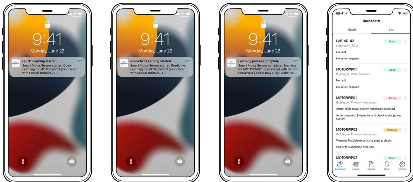
Lorsque des régimes, des températures ambiantes ou des charges différentes de celles initialement apprises sont détectés pendant le fonctionnement supposé normal du moteur, le SERMES SMS le détecte et déclenche une alarme. Veuillez contacter SERMES si vous avez besoin d'aide.
