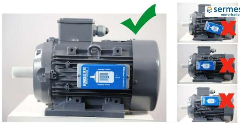
Respectez l'alignement et le positionnement de l'appareil
