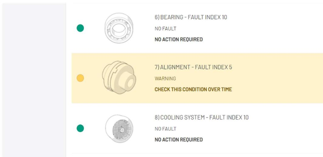
Figure 7. Composant qui pourrait nécessiter une intervention prochainement (jaune)
